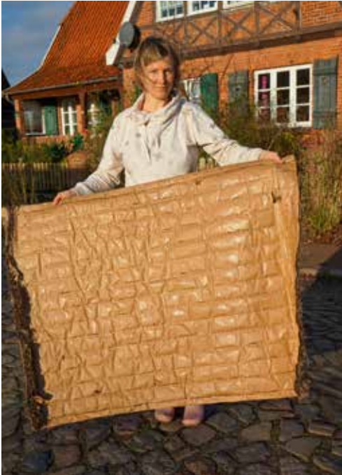
2 Historische Dämmmatten mit Seegrasdämmung kann man in vielen alten Häusern noch finden
