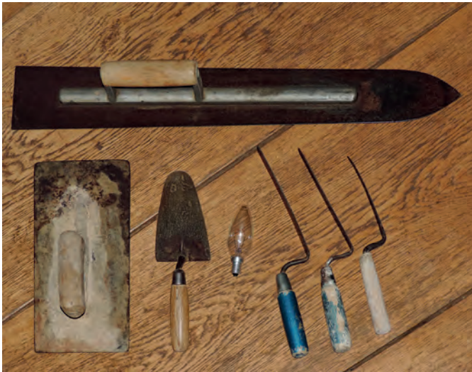
2 Unsere wichtigsten Lehmbauwerkzeuge: Die spitz zulaufende Glättkelle (Steinholz), oben im Bild, eignet sich gut zum übergangsfreien Abziehen von glatten Flächen. Von Links: Die Glättkelle zum Aufziehen der Putzschichten, die universelle Maurerkelle, eine Glühbirne zum glatten Ausstreichen der Ecken und verschiedene Fugenkellen zum Verfüllen von Rissen (Foto: Michael Meier)
